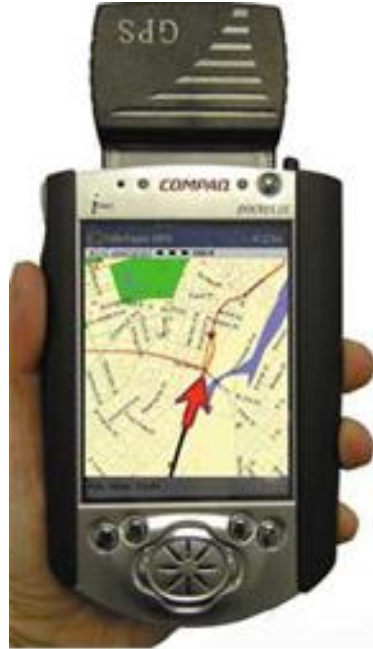
صورة رقم (١) جهاز من شركة كومباك يستخدم نظام GPS لتحديد الموقع
